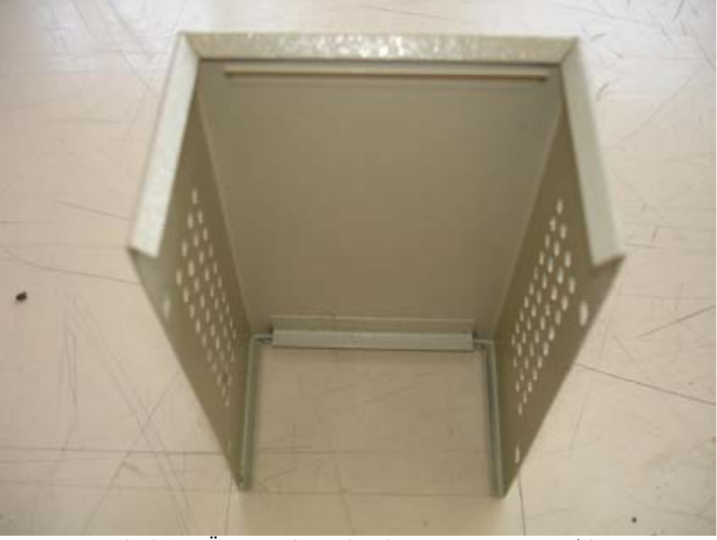
Şekil 1.7: Üst sacın vida delikleri açılmış ve bükülmüş hâli
