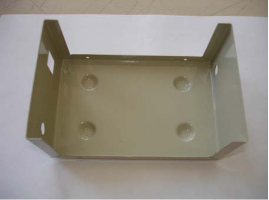
Şekil 1.8 : Alt sacın delikleri açılmış ve bükülmüş hâli
