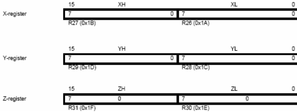
Şekil 2.3.1.2 X,Y,Z registerlerinin ram üzerindeki yerleşimi
