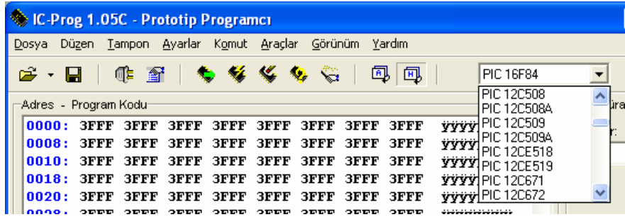
Şekil 1.37. Mikrodenetleyici türünün belirlenmesi
