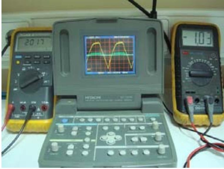
Resim 6.9. Hazırlanan devrenin tam yükteki PFC'li dalga şekli
